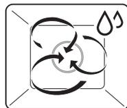
L'aria della camera di cottura viene riscaldata dall'apposito elemento dietro la parete posteriore e circola in modo uniforme. L'umidità propria generata dagli alimenti viene mantenuta all'interno della camera di cottura. L'alimento si secca meno.
