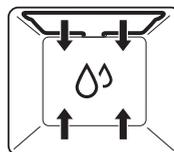
Il riscaldamento avviene mediante l'elemento riscaldante superiore e inferiore. L'umidità propria generata dagli alimenti viene mantenuta all'interno della camera di cottura. L'alimento si secca meno.
