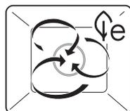
Questo modo di funzionamento consente un notevole risparmio di energia. L'aria della camera di cottura viene riscaldata dall'apposito elemento dietro la parete posteriore e circola in modo uniforme. L'umidità propria generata dagli alimenti viene mantenuta all'interno della camera di cottura. L'alimento si secca meno.
